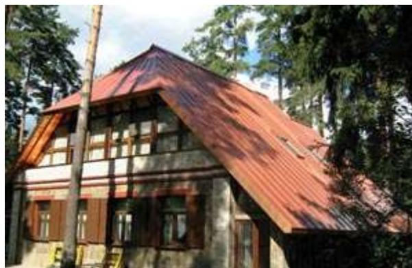
Если серый цвет мембраны, использованной при реализации проекта «Сити-Парк», имитировал алюминий или титан-цинк, то при строительстве частного дома в Подмосковье было применено иное решение. Здесь на площади 460 м<sup>2</sup> имитируется традиционная медная кровля, столь популярная ныне у состоятельных домовладельцев.
